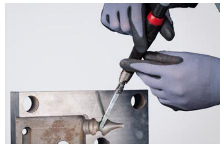
Pour un travail manuel plus ergonomique, nous recommandons d'utiliser un manche à serrage rapide. Pour une meilleure finition de surface, il convient d'utiliser de l'huile à rectifier. Il est important de trier les pierres à polir par catégorie pour éviter le mélange des grains.
