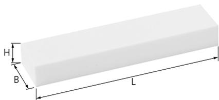
Serve a ripristinare la taglienza dei dischi abrasivi diamantati e CBN con legante resinoide. Il blocco per ravvivare viene prima impregnato di una sostanza refrigerante e poi utilizzato. Durante la molatura riacquista velocemente la taglienza originaria.
