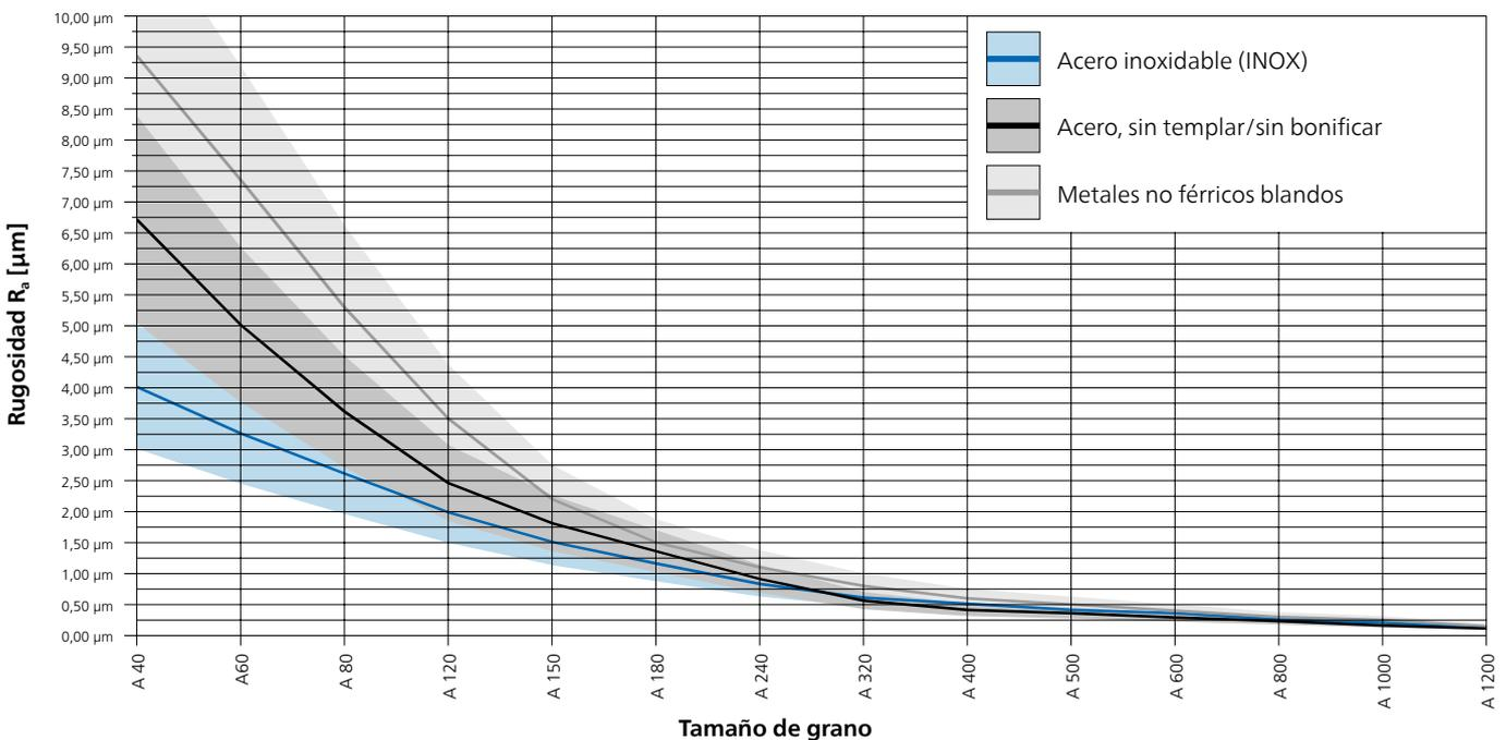
Rugosidad de la superficie de diferentes materiales una vez mecanizada la superficie con herramientas abrasivas con soporte.
