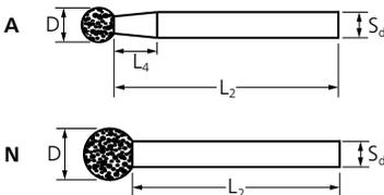
Las puntas de desbaste esféricas de CBN se utilizan a menudo para la fabricación de grabados o contornos y para trabajos de desbarbado.
