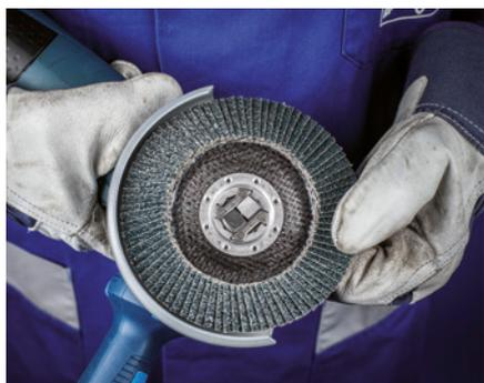
Coloque la herramienta en el sistema X-LOCK.
