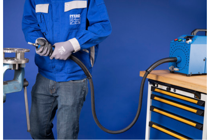
Verkeerd opstellen van de buigzame asmachine: Buigzame as motor- en/of handstukzijdig geknikt.
