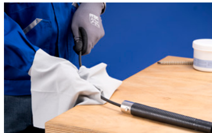
Binnenkabel met niet-pluizende reinigingsdoek ontvetten.
