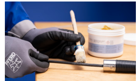
Aansluitend nieuw speciaal assenvet op de binnenkabel aanbrengen.
