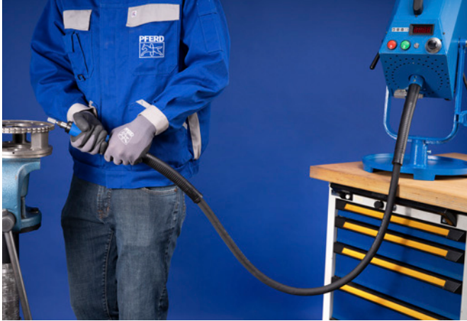
Placement correct de la machine à transmission flexible : Mouvement fluide sans pliure.
