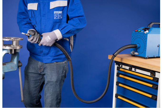
Placement incorrect de la machine à transmission flexible : la transmission flexible est pliée côté moteur ou porte-outil.
