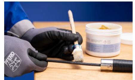
Ensuite, graisser l'âme avec une graisse spéciale.
