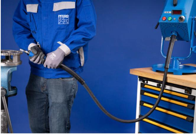
Colocación correcta de la máquina con eje flexible: impulso suave del eje flexible sin curvas.
