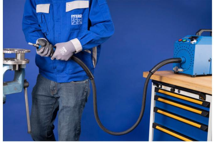
Colocación incorrecta de la máquina con eje flexible: eje flexible curvado en el lado del motor y/o la empuñadura.
