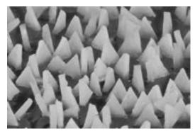
Natürlich legten die meisten Anwender Wert auf die enorme Leistungsfähigkeit des dreieckigen, präzisionsgeformten Hochleistungsschleifmittels. "Leistungsmäßig übertrifft **VICTO**GRAIN andere, etablierte Lösungen um bis zu 30%, und das bei gleichbleibend hoher Aggressivität", so Heimann. Das
